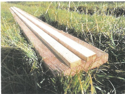
Abbildung 8: Brett mit Führungsleiste, in die die Holzplatte unten eingefügt wird. Dies garantiert, dass Das Brett stabil im Boden verankert ist und nicht absinkt. Eine solche Führungsleiste soll bei Holzplatten mit Überlauf eingebaut werden.
